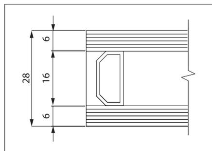
Sulle ante i vetri vengono montati in via definitiva. Sono spessorati con distanziali di materiale plastico, posizionati opportunamente lungo il perimetro delle ante. Vengono fissati con un fermavetro di materiale plastico, sul quale sono ricavate le asole per la ventilazione.
