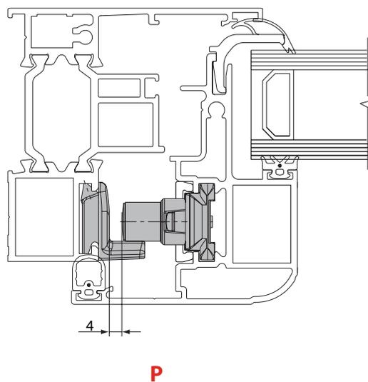
**PUNTI DI CHIUSURA ANTIEFFRAZIONE:** E' possibile richiedere l'applicazione di punti di chiusura supplementari per elevare il grado di resistenza dell'infisso a eventuali tentativi di effrazione. Anche in questo caso il numero e la posizione varia in funzione delle dimensioni dell'infisso. Il supplemento di prezzo sarà oggetto di specifica offerta commerciale.
