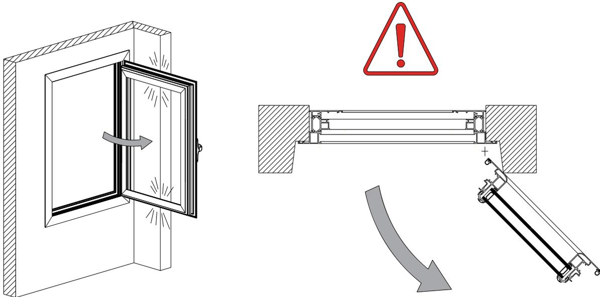
I bracci limitatori sono applicabili nella traversa inferiore e superiore dei serramenti, questi sono un optional, ma obbligatori nelle aperture a contrasto. Nelle porte con soglia a pavimento sono applicabili nella parte superiore limitatamente alle aperture ad anta.
