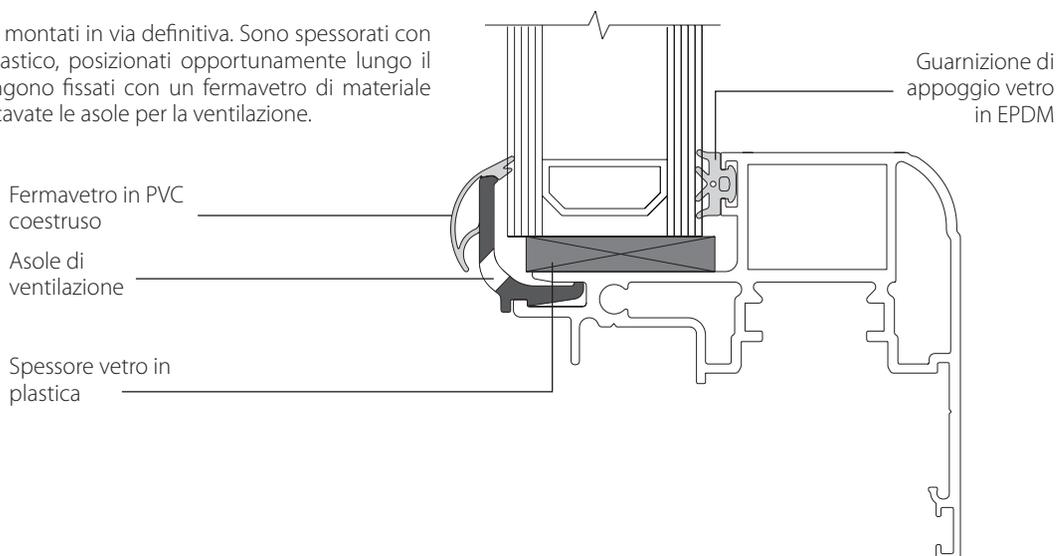
Sulle specchiature fisse i vetri si applicano con fermavetri a scatto in alluminio di tipo tradizionale. Su questi infissi i vetri vengono forniti montati nella loro sede, ma non bloccati in modo che possano essere facilmente rimossi per consentire il fissaggio del telaio al muro. Le guarnizioni e gli spessori necessari non sono compresi nella fornitura.
